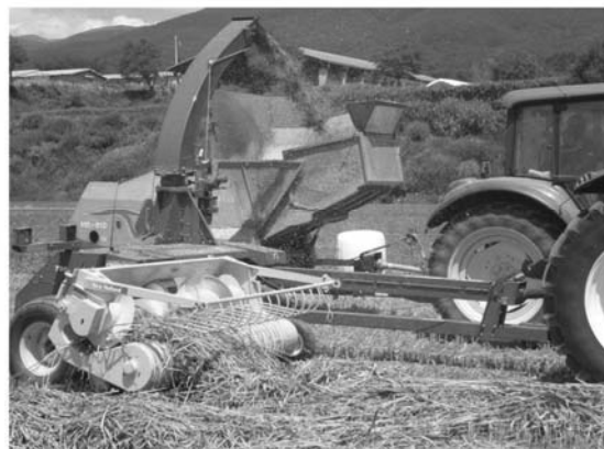
写真4 モーアコンディショナとフォーレイジハーベスタによる「涼風」の収穫体系
