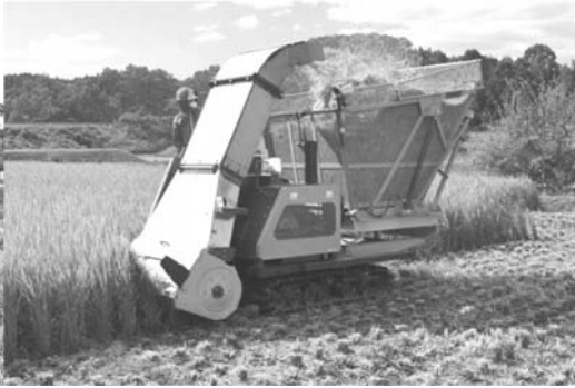
4号機：小型長稈対応、フレール型
