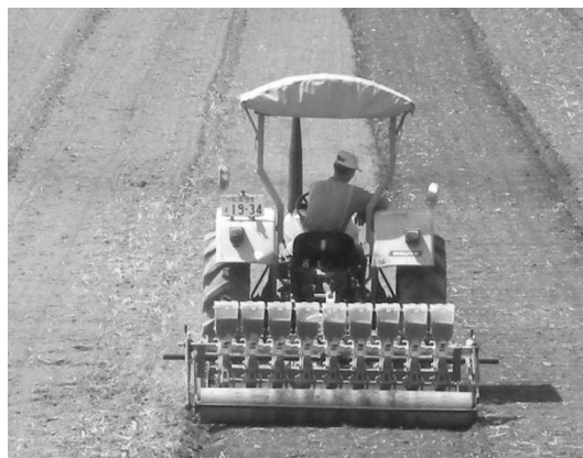
写真1 ロータリシーダによる密条播（後部の鎮圧ローラの回転に連動して種子が繰り出す）
