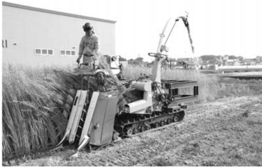
1号機：長稈対応、コンバイン型
