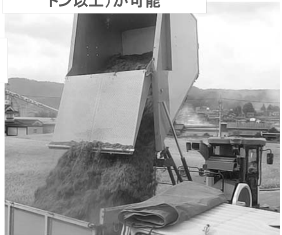
1回で2トンダンプに移送(1トン以上)が可能
