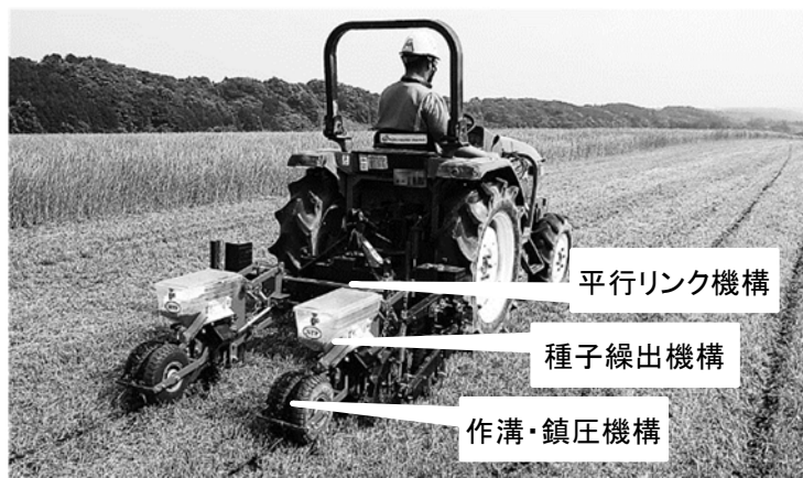
図1 実用化された開発機の外観（イタリアンライグラス収穫跡での不耕起播種作業）
