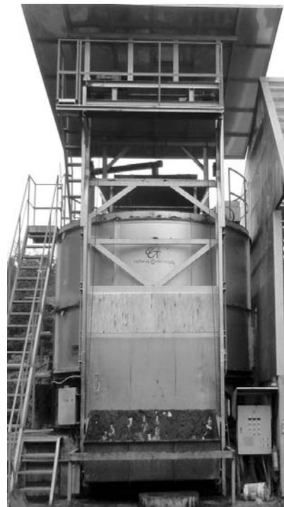
図 1 密閉縦型堆肥化装置
