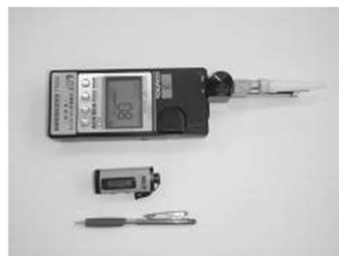
写真1 畜環研式ニオイセンサ （下段はGPSロガーとボールペン）
