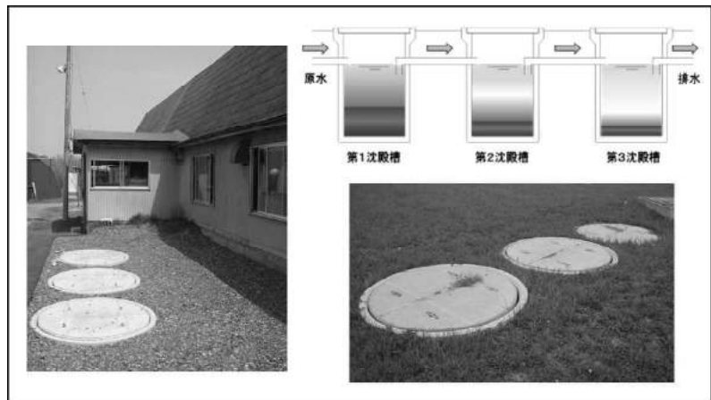
図5 3槽越流式沈殿槽 (北海道H町の約150戸の酪農家に導入されている)
