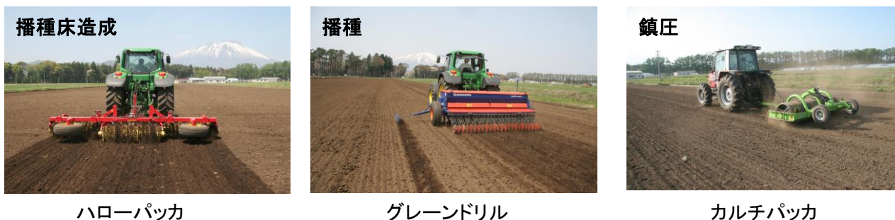
図2-43 グレーンドリルを用いた乾田直播の播種体系
