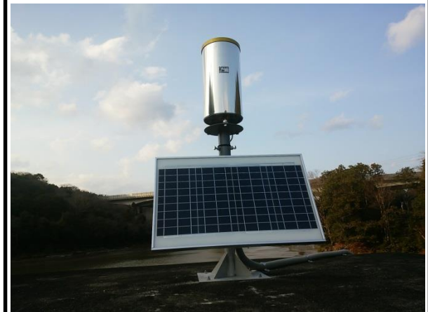
雨量計、ソーラーパネル
