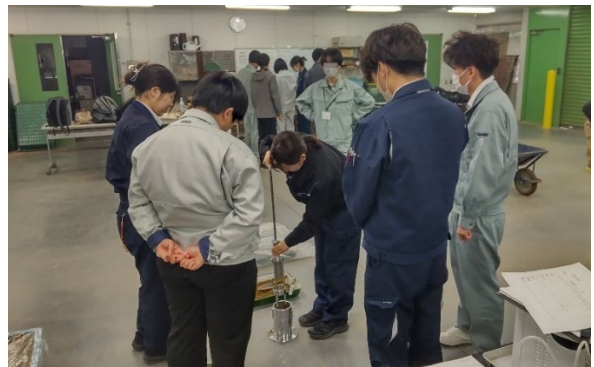
土質試験実習（締固め試験）
