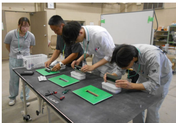
摩耗計測（型取りケージ）
