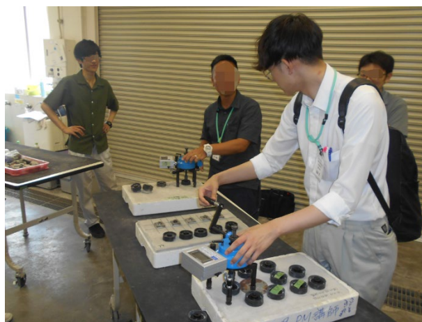
現場付着強度試験
