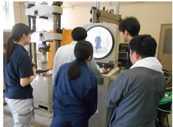
コンクリート試験実習（圧縮強度試験）
