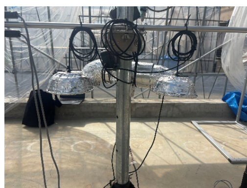
図 4. 遮光・通風形態の異なる 温湿度センサによる計測の様子
