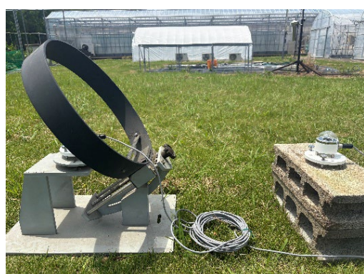
図 3. 遮光バンド付き全天日射計（左）と 全天日射計（右）による日射量計測の様
