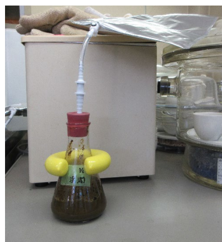
図3 メタン発酵試験 (バイオガスの捕集)
