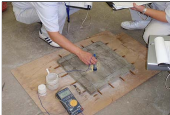
供試体による自然電位測定状況
