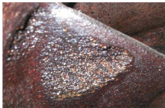
写真4 羽根車の孔食
