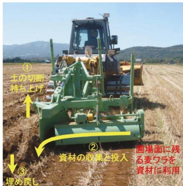
写真1 カッピングソイラ工法の施工手順
