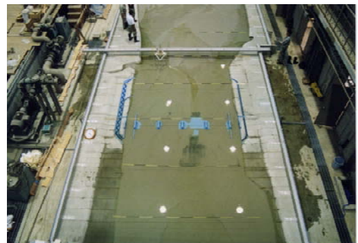
写真3 実験終了後の新堰の付近
