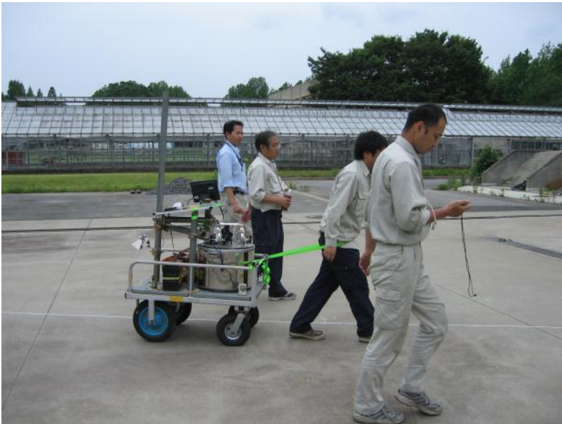
▲農村工学研究所内でのドップラー速度計のチェック
