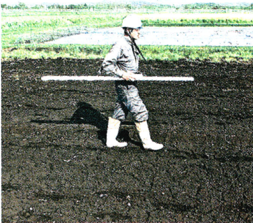
肩掛け式の電磁波調査機器。農地で持ち歩いてEC値を計測できる（東北農業研究センター提供）
