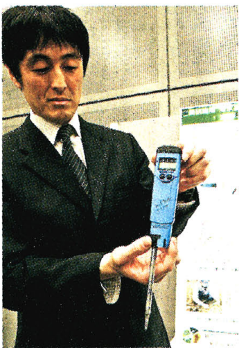
採取した土に突き刺してEC値を測る機器（6日、盛岡市で）
