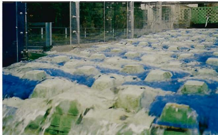
突起ブロック模型による水理実験
