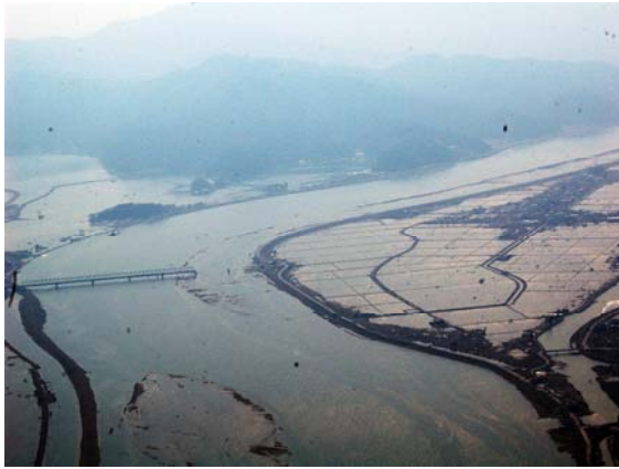
【宮城県追波川河口近くの農地の被害】 追波川を遡上した津波が河川堤防を越流し、農地が完全に湛水。河川橋梁が一部流失していることも上空から確認。
