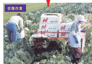
北陸地域では重粘土水田が広く分布していますが、転換作物として野菜を栽培する場合、灌水、薬剤散布等の圃場内作業は作業機の、走行性を低下させずに機械化を図ることが重要です。一方、キャベツ等の重量野菜の栽培では、収穫作業が最も労働の負荷が大きく、特に長辺方向が長い圃場では、搬出の際の労働負荷が問題となっています。そこで収穫時の搬出作業に利用効果の大きいクローラ運搬車に、ブーム、動力噴霧機やタンク等を搭載して使用できる汎用性の高い各種管理作業用アタッチメントを開発しました。
