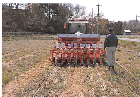
写真1 ディスク駆動式不耕起播種機による播種作業
