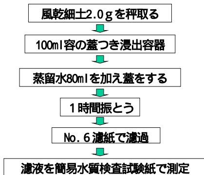
図6 土壌の水浸出りん酸の簡易測定手順
