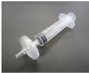
図1 シリンジにディスポーザブル フィルターを装着した様子
