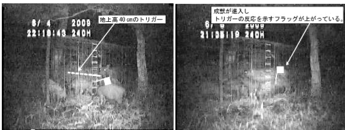
図4 トリガーの反応（幼獣は素通り、成獣では反応）
