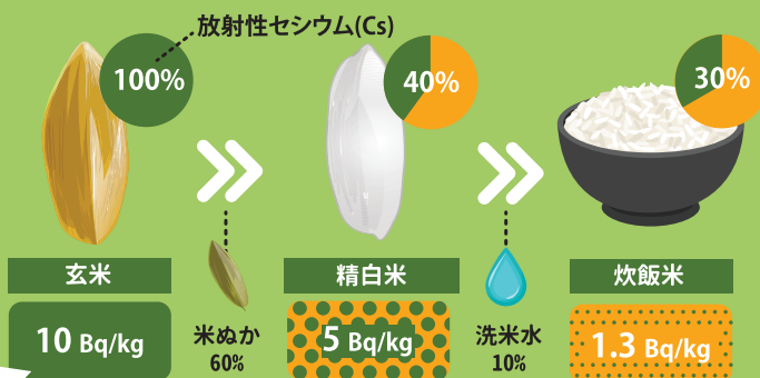
炊飯米になるまでに玄米から放射性セシウムが分かれる割合 (%)
