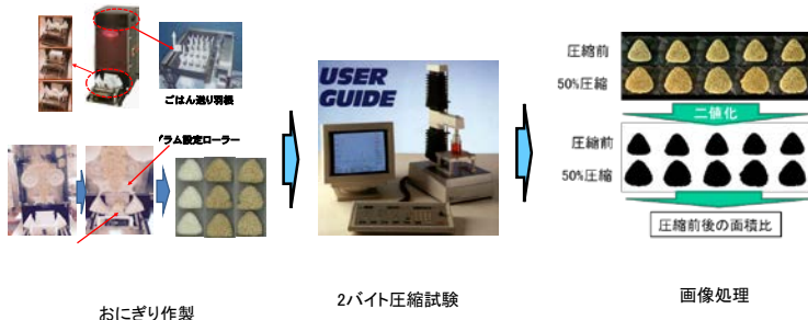
図2 圧縮試験におけるおにぎりの二次画像の面積比の算出方法
