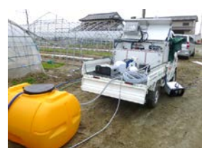
現地での地下水脱塩試験
