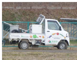
EVと可搬型RO装置
