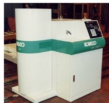
実験に使用した高圧処理装置 Dr.CHEFF(神戸製鋼)
