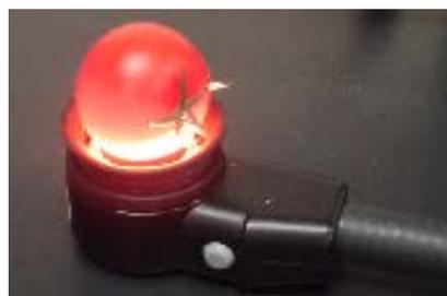
測定時の集光性が良く、低コストかつ高精度な計測が可能な拡散反射(インタラクタンス)モードによる非破壊計測
