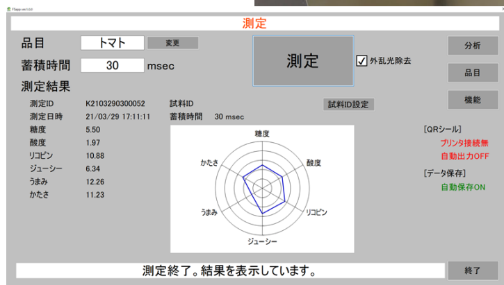
測定結果の表示画面例。 表示項目は10項目まで搭載可能。
