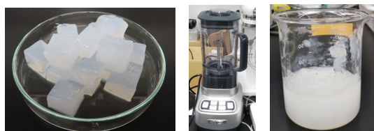
図1 ナタピューレの調製 ナタデココ（左写真）を(1-3),(1-4)- \beta -グルカンの存在下で家庭用ブレンダー（中央写真）で離解すると、離解物「ナタピューレ」（右写真）が得られる。
