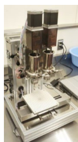
図3 3Dフードプリンタ（左写真：3Dフードプリンタ FP-2500 （世紀株式会社））での円筒状成形物の積層試験結果 中写真：水のみでのペースト（ジャガイモ粉濃度22.5%） 右写真：ナタピューレを添加したペースト（ジャガイモ粉濃度20%）
