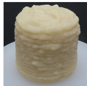
図3 3Dフードプリンタ（左写真：3Dフードプリンタ FP-2500 （世紀株式会社））での円筒状成形物の積層試験結果 中写真：水のみでのペースト（ジャガイモ粉濃度22.5%） 右写真：ナタピューレを添加したペースト（ジャガイモ粉濃度20%）
