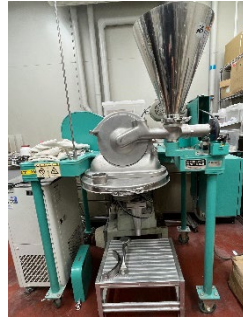
ジェットミル IDS-2, 日本ニューマチック工業 ハンマーミル 1018-S-3, 吉田製作所
