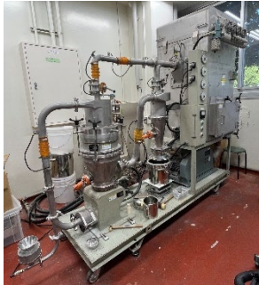
ジェットミル IDS-2, 日本ニューマチック工業 ハンマーミル 1018-S-3, 吉田製作所
