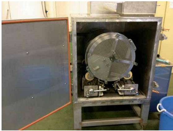
図1 酢酸ガス大型処理装置
