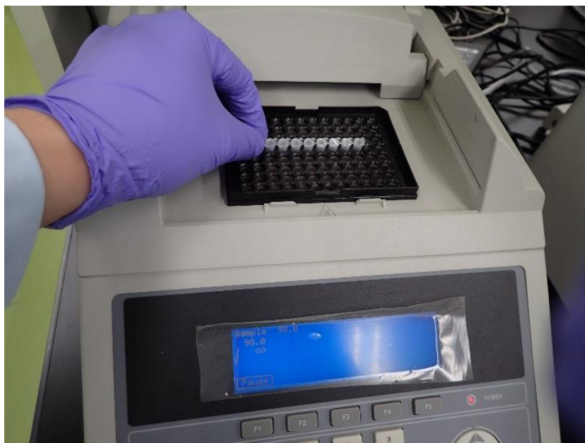
写真 47 熱変性処理を行うため、RNA およびプライマーの入った PCR チューブを 98℃に設定したサーマルサイクラーに入れる様子
