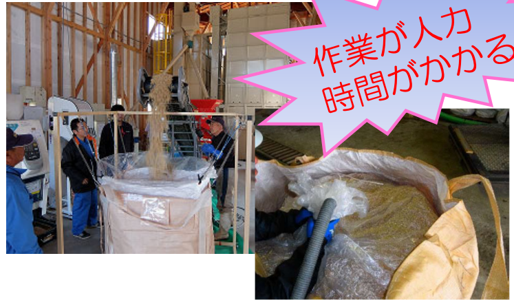
< 内袋付きフレコンへ詰め込み ・ 掃除機で脱気 ・ 密封 >
