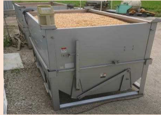
穀物コンテナを利用した子実トウモロコシの通風乾燥装置
