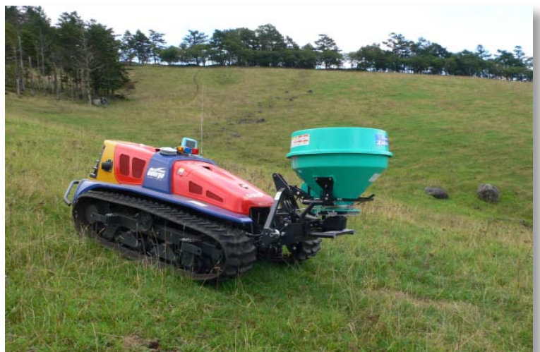
傾斜地用無線トラクタによる施肥
