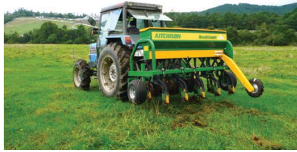
シードマチックを取り付けたトラクタ
