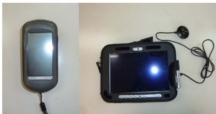
写真 1. 携帯型 GPS（左）と外付け GPS 受信機を取り付けたポータブル PC（右）。
