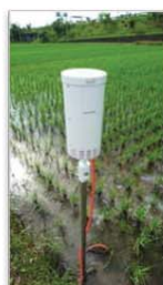
低コストで省力的な水管理を可能とする水田センサー(目標価格:1万円)
