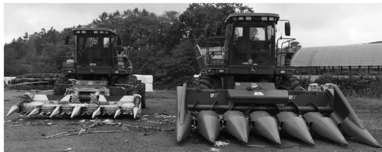
図 2. スナッパヘッド装着自走式ハーベスタ（右）。左奥はホールクローブ収穫用アタッチメント（ロータリーヘッド）装着の自走式ハーベスタ
