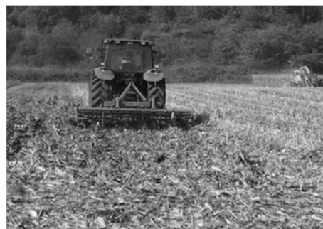
図 3. ディスクハローによるエアコーン収穫残さ処理の様子
