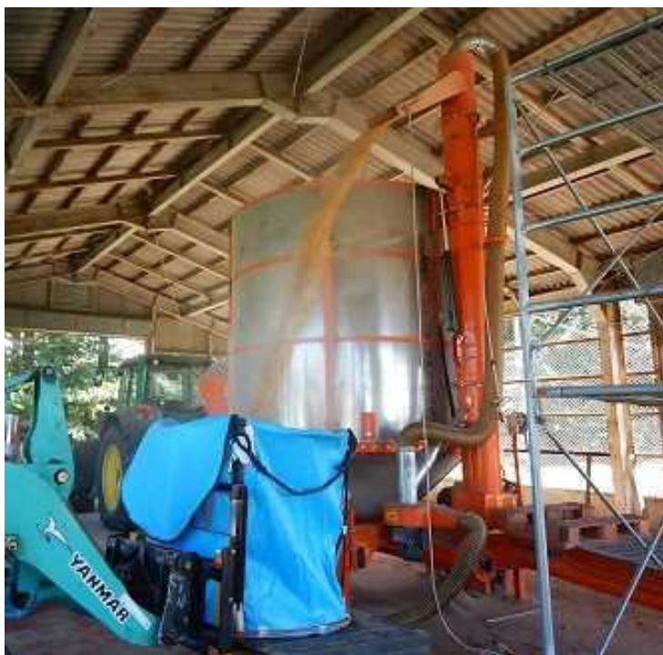
AGREX SpA社 (イタリア) 製 AGD-10 (東北農研での乾燥調製の様子)
