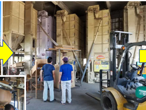
遠赤外線循環型乾燥機 (トウモロコシ対応機種を増設、 目標水分15%)
