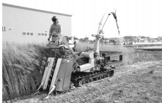
1号機：長稈対応、コンバイン型
