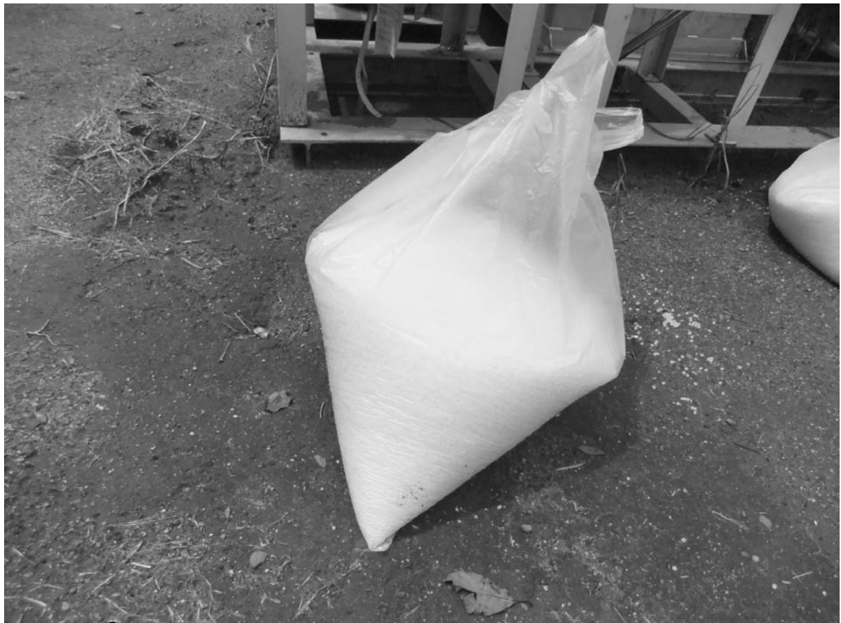
1m 3 の膜浸漬槽 78 に投入した樹脂粒
