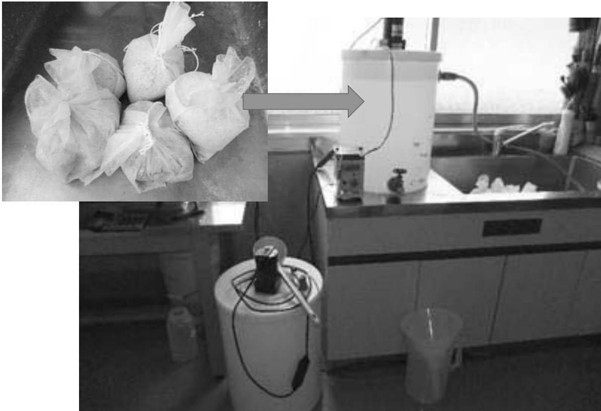
古紙粉末による脱窒実験装置（約50L）
