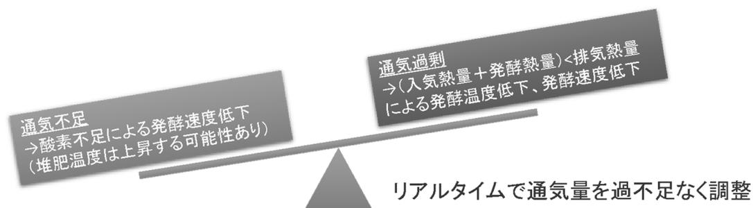
図 5 排気発酵熱量を発酵指標とした通気制御ロジックの概要
