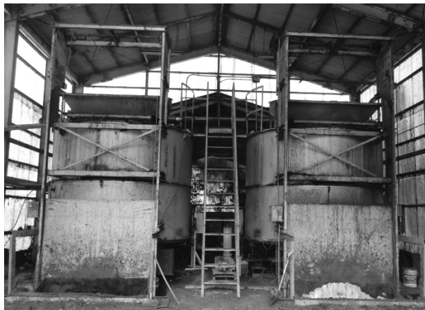
図1 実証農場の密閉縦型堆肥化装置
