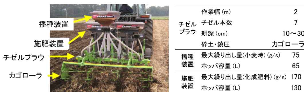
図 2-1 簡易耕同時播種の播種機(チゼルプラウシーダー)と主要諸元
