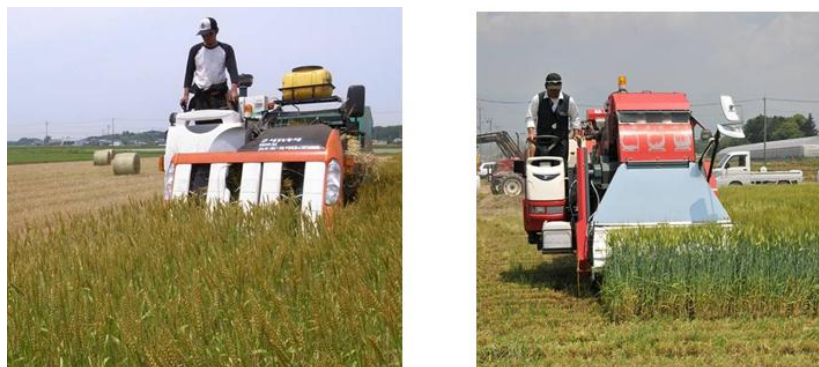
図 3-2 飼料用イネ専用収穫機による飼料用麦類のダイレクト収穫作業
