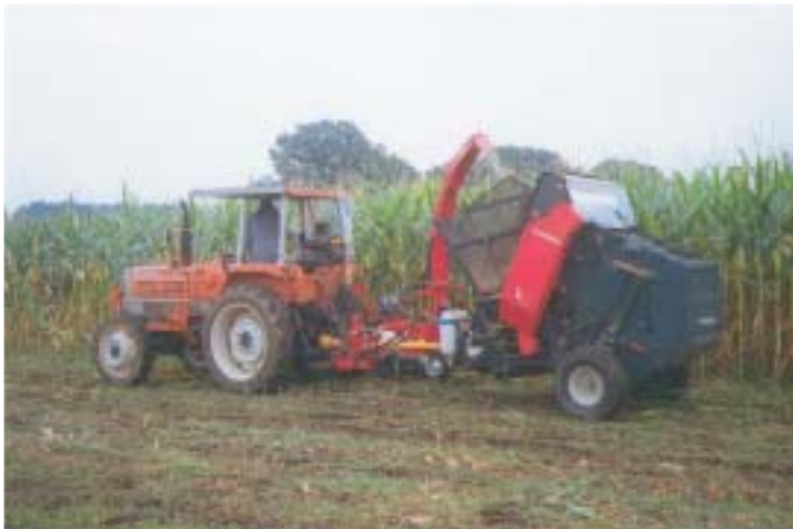
①細断してベアラに吹き込み、成形する。
