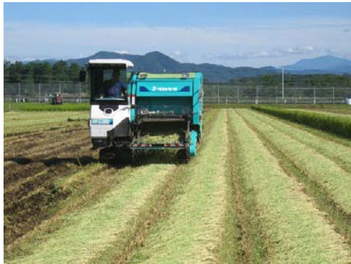
図4 自走ロールベアラによる作業 ベール径・巾1.2m
