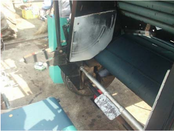
側壁に取り付けた側圧板
