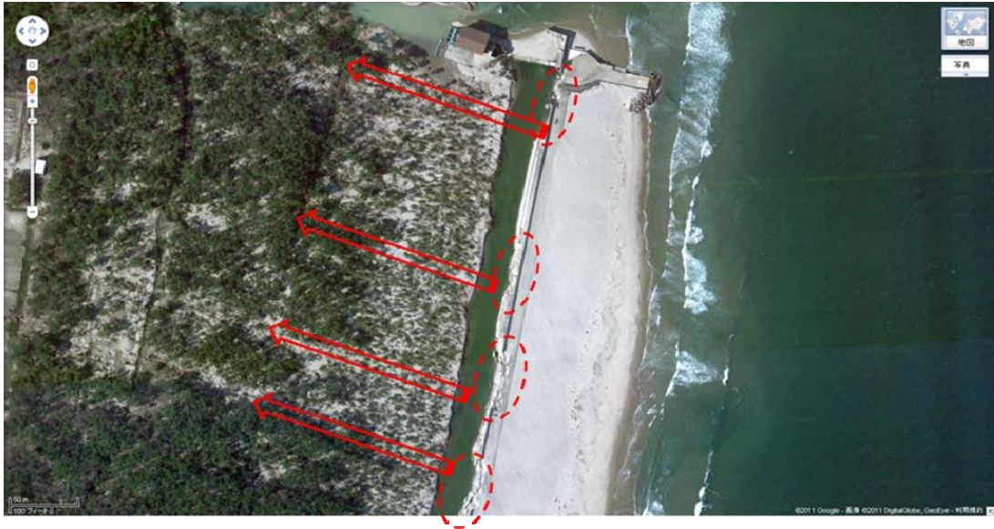
写真1 亙理農地海岸 吉田排水機場周辺のGoogle Map 写真 海岸堤防の消滅（楕円）している部分と松林の流出（矢印）の間に対応関係が見られる。
